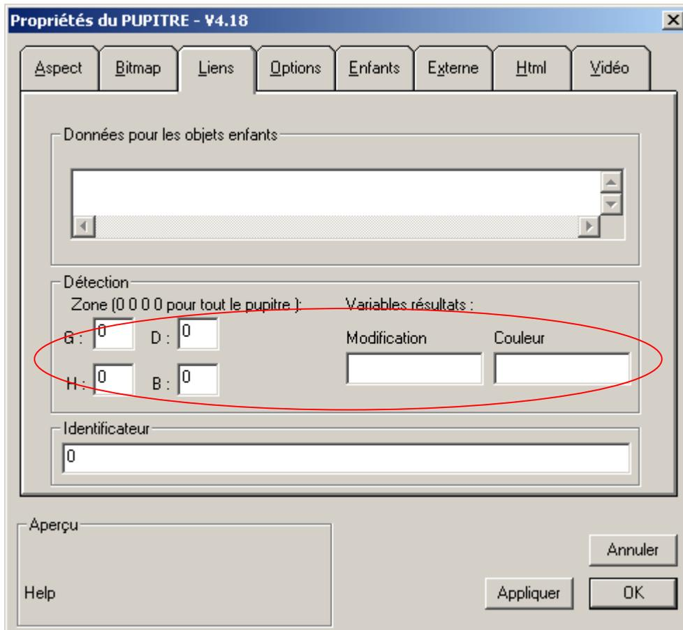
Les paramètres « Détection » de l'onglet « Liens » permettent de définir des fonctions de détection sur la surface du pupitre. Ceci est particulièrement utile avec les pupitres utilisant une source vidéo pour réaliser une détection de mouvement ou de couleurs.
