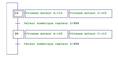
Le principe du programme proposé est simple : les moteurs sont toujours activé (étape 0), on module ensuite leur vitesse. Le robot tourne dans un sens (pour tourner, il suffit de faire tourner un des 2 moteurs plus vite que l'autre) jusqu'à atteindre une limite d'intensité lumineuse, lorsque cette limite est atteinte, le robot tourne de l'autre côté et ainsi de suite.
