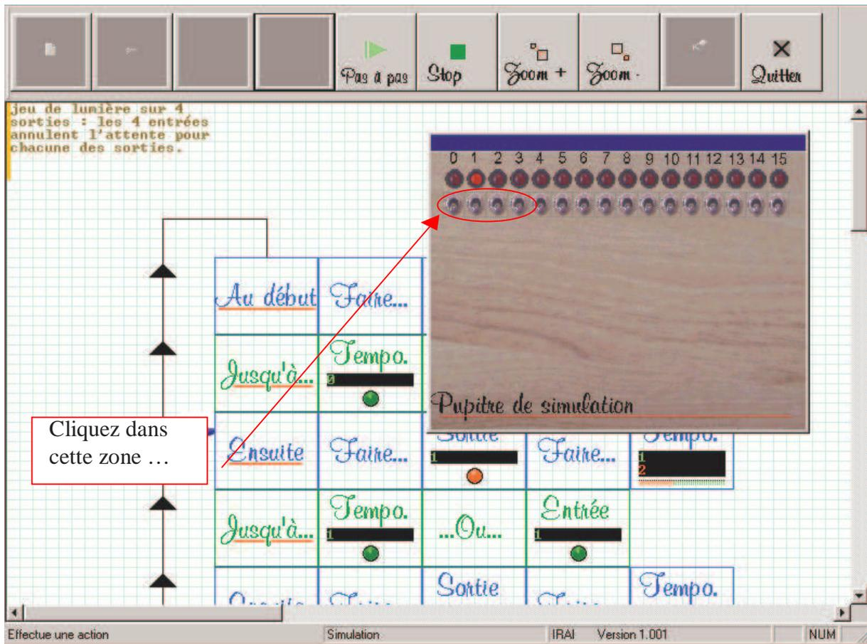
Remarque : l'appui sur les interrupteurs avec le bouton gauche de la souris les fait changer de position (bistable), avec le bouton droit, l'interrupteur reprend sa position au relâchement (monostable).
