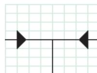
permettent d'aiguiller l'exécution d'un programme vers une branche ou une autre.
