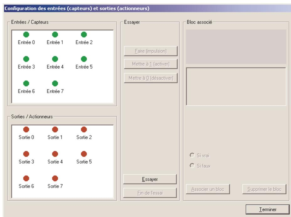
Le bouton « Essayer » permet de piloter manuellement les sorties de l'interface connectée ainsi que de visualiser l'état des entrées. Le bouton « Associer un bloc » permet de créer un élément de programmation qui deviendra accessible en phase de programmation.
