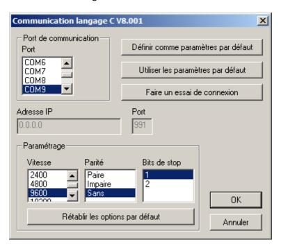
Sélectionnez le port de communication correspondant à celui où le module Arduino est connecté.
