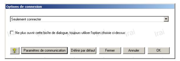
Le mode de connexion doit être "seulement connecté", le téléchargement est en effet réalisé par l'intermédiaire du logiciel Arduino.
