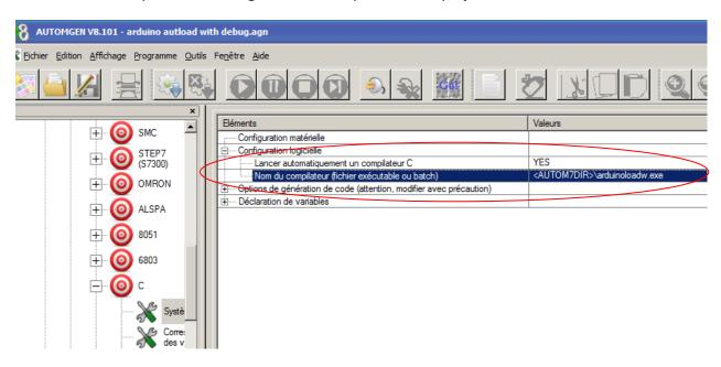
Le logiciel Arduino doit être lancé avant le lancement de la compilation. Le type de carte et le port de communication utilisé doivent être réglés dans ce logiciel.
