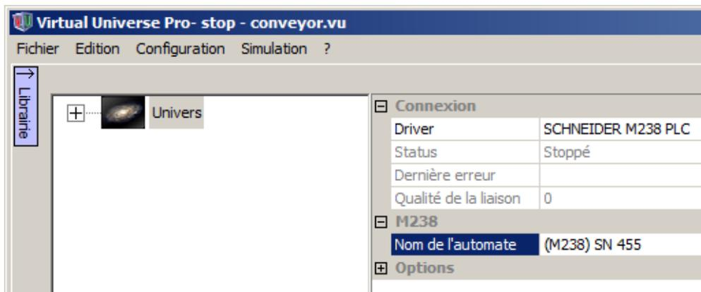
Le nom de l'automate doit être le même que celui sélectionné dans le logiciel SoMachine lors de la connexion :
