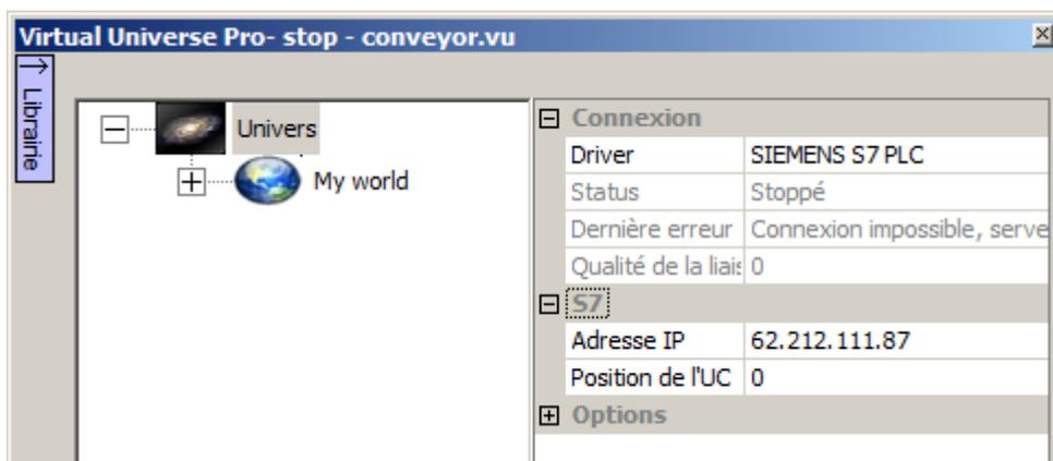
L'adresse IP de l'automate doit être renseignée sous la rubrique S7/Adresse IP. Pour les automates S7-400, la position de l'UC dans le rack de l'automate doit également être renseignée sous la rubrique S7/Position de l'UC.
